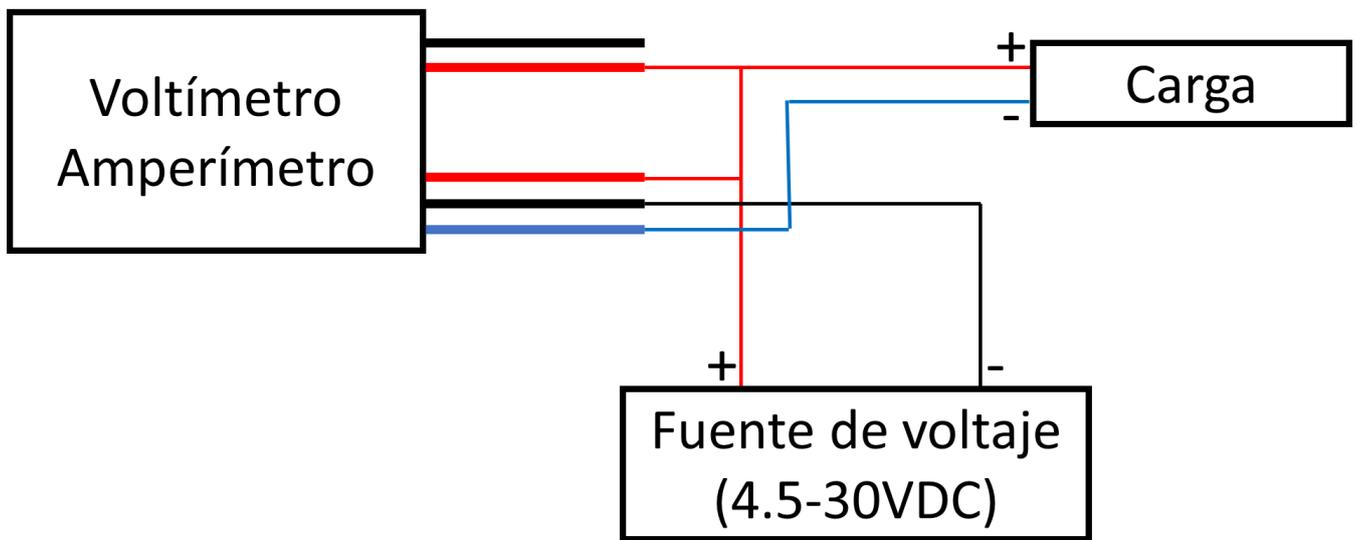
Medidor para voltajes de 0-100VDC
